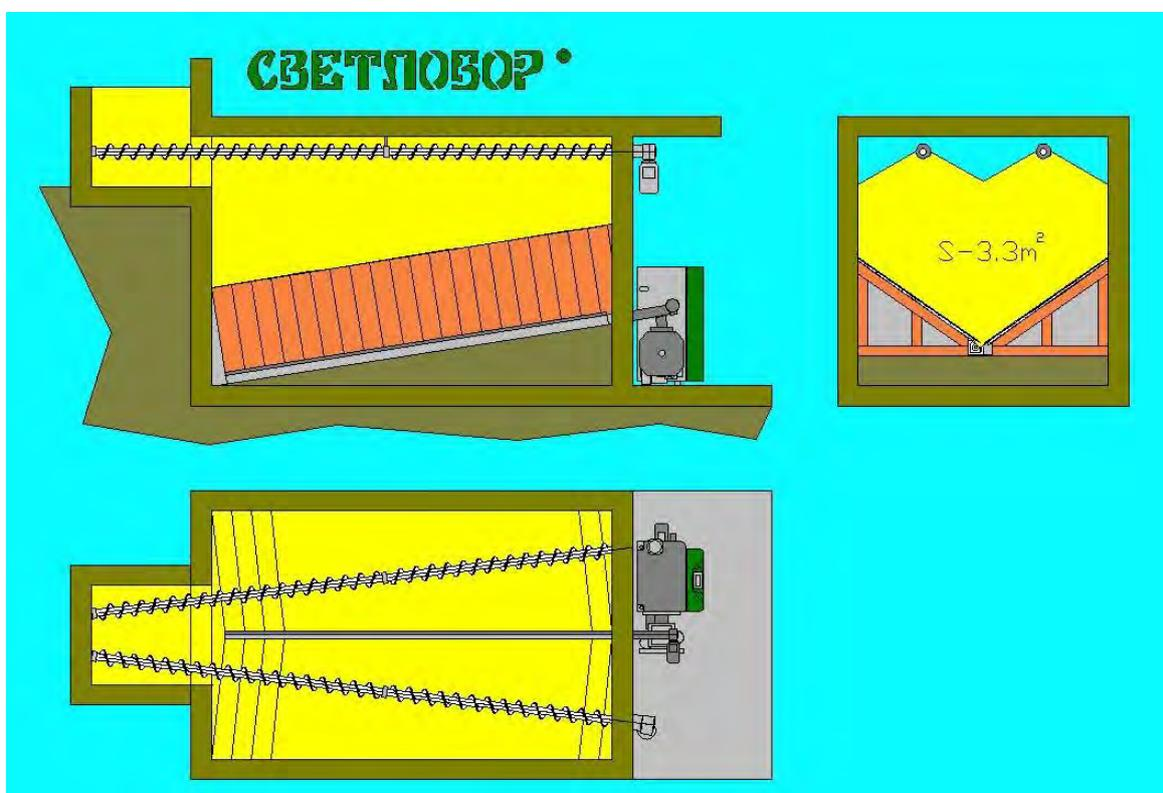
Размер склада ДхШхВ – 4000х2500х2500. В складе расположен наклонный конвейер (продольный угол 7 гр). Деревянные скосы имеют наклон в 35 гр. Вверху склада установлены два загрузочных шнека большого диаметра. Площадь поперечного сечения склада около 3.3 м<sup>2</sup>. Кубатура склад при длине 4 м равна 13 м<sup>3</sup>, или 8800 кг пеллет. Расчетная потребность в пеллетах ВД20, при отоплении дома в 200 м<sup>2</sup> составляет 8300 кг за сезон.
